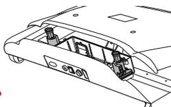
Благодаря наличию предохранительного переключателя в цепи электропитания, кресло автоматически прекращает выполнение всех функций при наличии слишком сильного давления на какую-либо часть кресла. За счет этого происходит предотвращение получения травм людьми.
