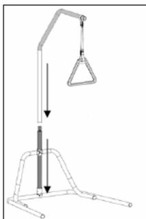
4. Соедините верхнюю часть «гуся» с треугольником и среднюю часть «гуся», зафиксируйте защелку. Соедините полученную конструкцию с базой надкроватной трапеции.
